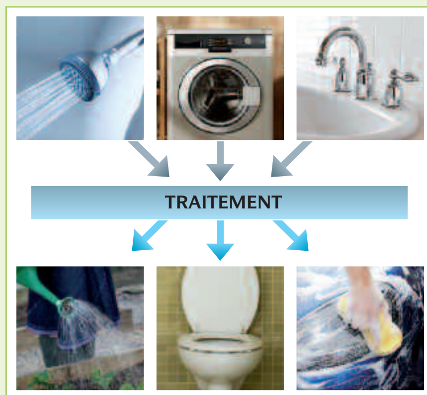
Schéma 1 : origines et réutilisation des eaux grises
